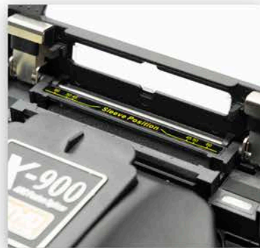
Calentador inductivo automático Calentamiento rápido
