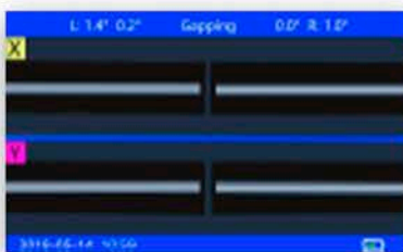
Imagen clara de Fibra y separación rápida de fibra
