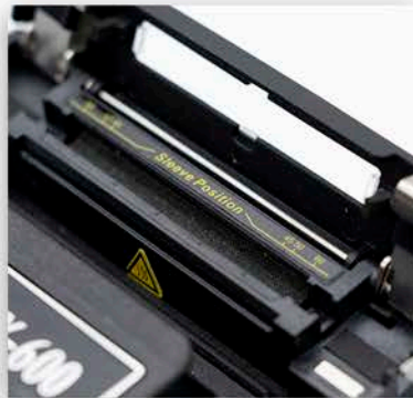
Calentador automático Inductivo No calienta sin colocar la fibra
