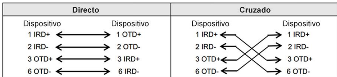
Figura 7-2 Conexiones de pares trenzados de 10BASE-T/100BASE-TX
